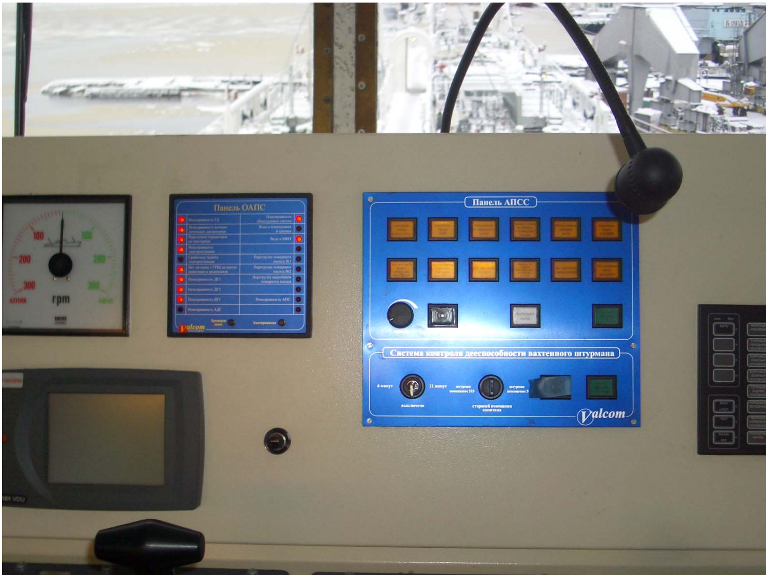
Рис. 3 Панели АПСС и СКДВШ в рулевой рубке
