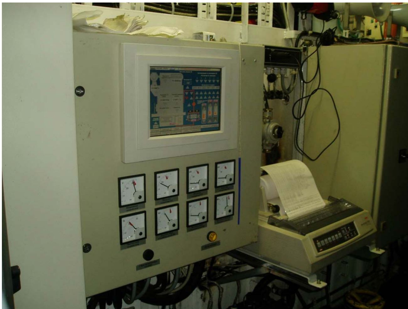
Внешний вид дублирующего пульта ИСУТС в машинном отделении судна
